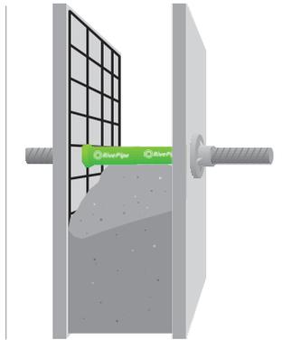
PASO 4: Adaptable a los diferentes grosores de muro
